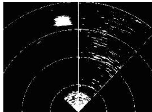
Fig. 34 (d) Results of the adaptive thresholding method
